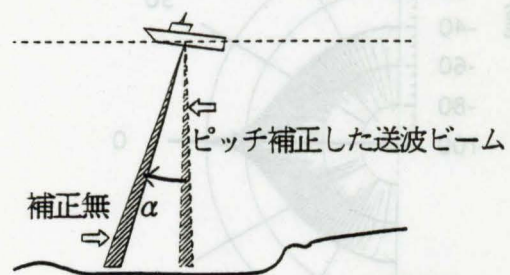
第5図 送波ファンビームのピッチ補正
