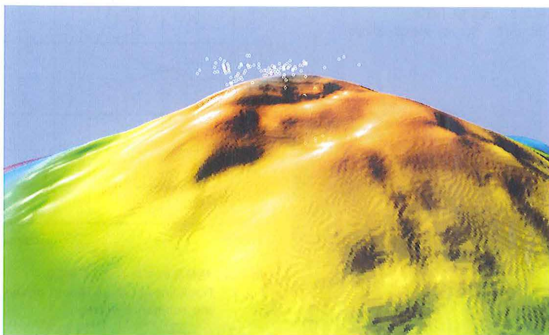
第4図 マンボウIIによる明神礁3次元表示図 Fig. 4 Three-dimensional view of the Myojin-sho submarine volcano obtained with the Manbo II.
