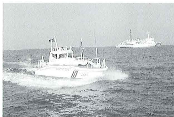
写真5 高性能特殊測量艇「じんべい」 Photo.5 Autonomous high-tech survey boat, Jinbei .
