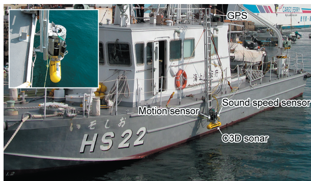
Fig. 2. C3D system deployed on S/V Isosio. 図2. 測量船「いそしお」に艙装した C3D システム。
