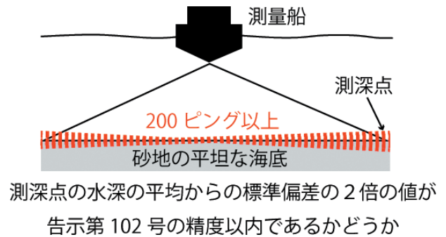
Fig. 3. Schematic image for the uncertainty test 1. 図3. 停船状態での測深精度の検証イメージ図。
