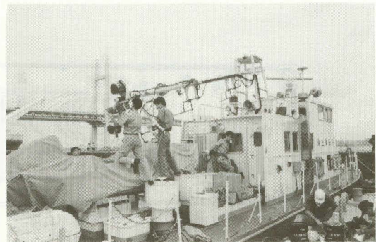
写真4 倒したマストの状態
